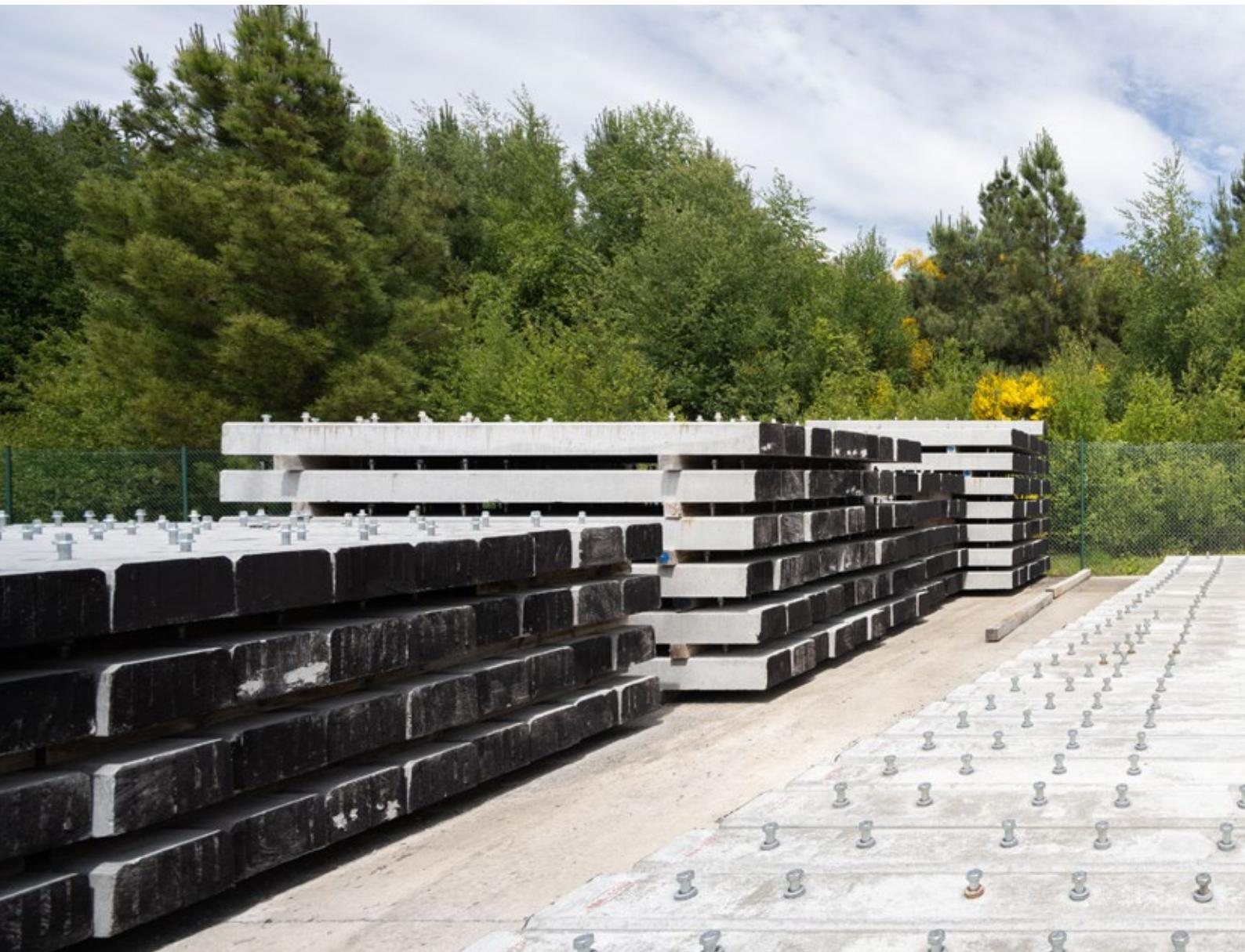
Esta Compañía tiene como actividad la fabricación de traviesas de hormigón para ferrocarril. La factoría, ubicada en Carballiño (Orense), cuenta con el sistema de fabricación tecnológicamente más avanzado, con una capacidad de producción de 1.440 traviesas/día.
